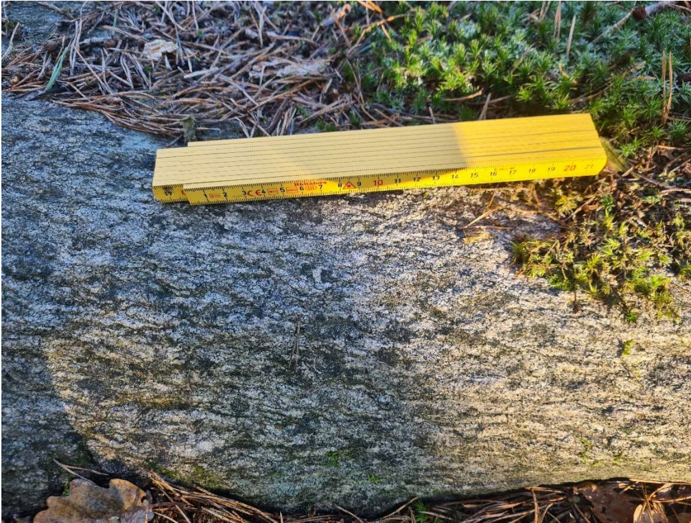
Figur 11. Berggrunden består av fint medelkornig, ojämnkornig tonalit-granodiorit med tydlig foliation.
